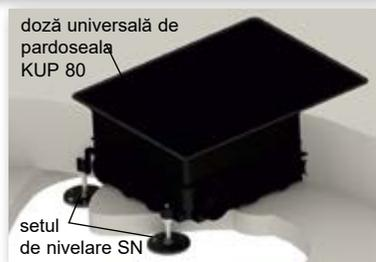
Setul complet al dozei de pardoseală, alcătuit din KOPOBOX® 80 și KUP 80, este destinat pentru instalarea aparatelor clasice și modulare 45x45. Alegerea tipului de aparate instalate se face conform tipului suportului de aparate. Plăci de fixare (destinate pentru montajul în pardoseala dublă) nu se folosesc pentru instalarea cadrului KOPOBOX® 80 în doza KUP 80.
