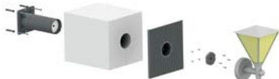
Este necesară tăierea suportului inclusiv izolația înainte de instalare, depinzând de grosimea stratului de izolație. Suportul este fixat pe perete cu suruburi și dibluri depinzând de tipul de suprafață a peretelui. Pentru instalarea prizelor de 400 V recomandăm fixarea cu ancore rezistente chimic. Apoi se va pune cablul prin suport. Doza sau platforma se fixează de suport cu patru suruburi (incluse în pachet).
